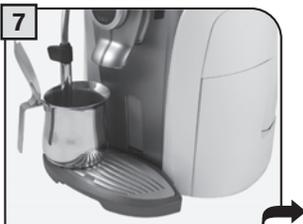
7 Einen Behälter unter das Dampfrohr stellen.
