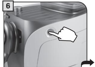
6 Den Hauptschalter bis zum Anschlag drücken, um die Maschine einzuschalten. Das Gerät führt eine Diagnose der Funktionen durch.
