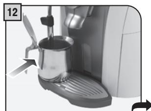
Einen Behälter mit entsprechendem Fassungsvermögen unter das Dampfrohr stellen.
